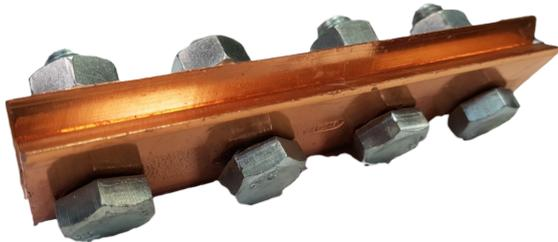
Está formada por dos llantas de cobre que aprisiona por la acción de los tornillos, la cabeza y cuerpo del carril, garantizando empalme eléctrico y mecánico. Las guías que amarran la base del carril aseguran alineación del mismo, evitando posible formación de “garrotes”.
