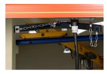
Monter le bras de guidage BA-4 fixé aux chaines du chariot aligné avec le centre de la gaine. Le bras doit rester au dessous de la gaine à environ 30/50mm.
