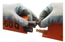
Insérez les extrémités des conducteurs en cuivre dans les connexions à ressort un par un, env. 5-10 mm
