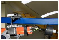
Réaliser la connection électrique en bout. Si la connection se fait en point central cela nécessite une alimentation Al-4Q et la connexion se fait en 2 points
