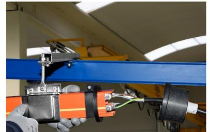
Réaliser la connexion électrique en bout. Si la connexion se fait en point central cela nécessite une alimentation AI-4Q et la connexion se fait en 2 points
