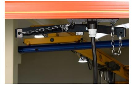
Monter le bras de guidage BA-4 fixé aux chaînes du chariot aligné avec le centre de la gaine. Le bras doit rester au dessus de la gaine à environ 30/50mm.
