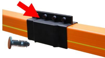
Mettre les boulons de fixation "clip" des couvre joints EMP-4Q. Vérifiez le bon alignement entre la poutre et la ligne électrique.
