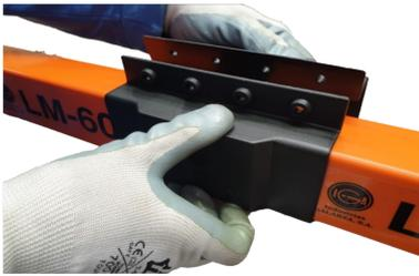
Recouvrez les connexions avec les couvre joints EMP-4Q, en veillant à ce que les côtés soient bien ajustés dans la partie inférieure du profil en PVC. Le joint central doit être monté entre les deux côtés.
