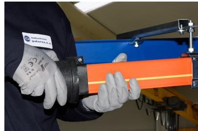
Fermer le bouchon à l'extrémité TE-4Q de la ligne pour éviter les contacts électriques indésirables.
