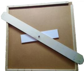
Las pletinas de cobre a insertar en el perfil de PVC se entregan en forma de rollo. Dicho devanador permite introducir las pletinas poco a poco, a medida que el taco de arrastre avanza a lo largo del perfil de PVC.
