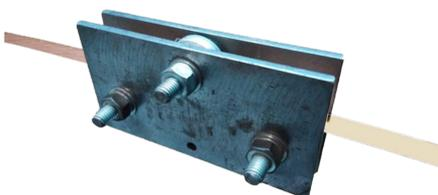
Sirve para enderezar la pletina de cobre antes de ser insertada en la carcasa de PVC
