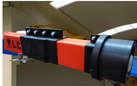
Montar tapas extremas al resto de la línea mediante sus respectivos empalmes. Los 200mm de longitud de tapa sirve para absorber las dilataciones y contracciones de la línea.
