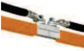
Conectar los cables eléctricos a ambos lados mediante los terminales.
