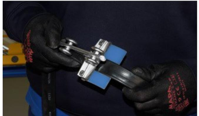
Couper la longueur nécessaire de câble électrique en laissant suffisamment de longueur des deux côtés pour faire les connexions électriques plus tard.
