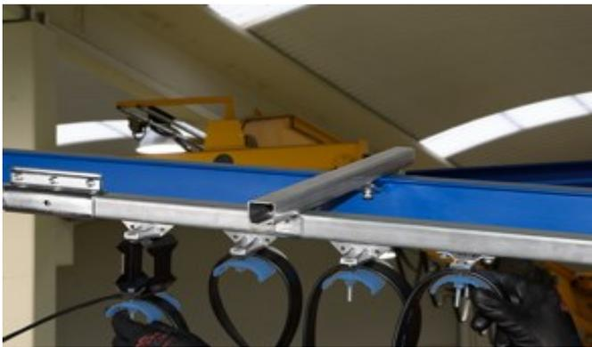
Insérez les chariots montés avec le ou les câbles dans le profil en commençant par le chariot entraineur, puis ensuite les chariots mobiles et terminer par le porte câble fixe. Le câble électrique doit être monté sans rotation.
