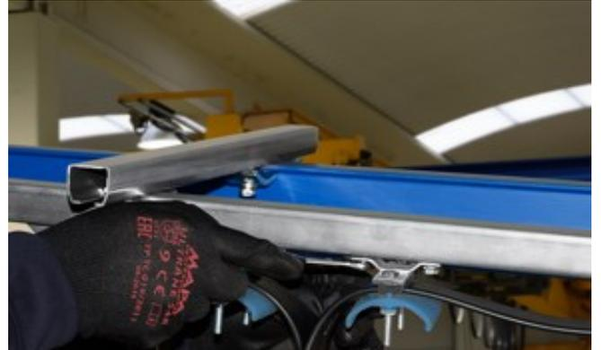
Serrez le chariot fixe à la fin du profil. Effectuez les connexions des câbles électriques des deux côtés de la ligne d'alimentation dans leurs boîtiers respectifs.
