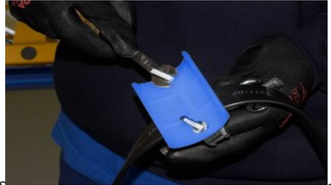
Serrez les vis des plateaux en évitant d'endommager les câbles électriques par un serrage excessif. L'ensemble des câbles doivent être aussi bien centré que possible sur le plateau afin que le chariot circule de manière équilibrée.
