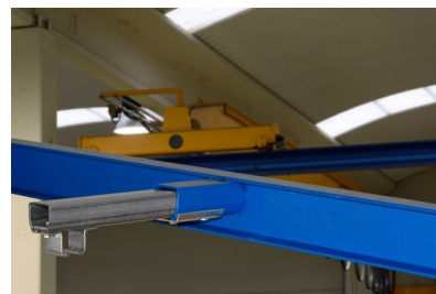
BRAS SOUDES A LA POUTRE
