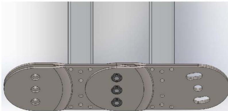
2.3. Fijar los marcos a la cadena mediante tornillos M-6
