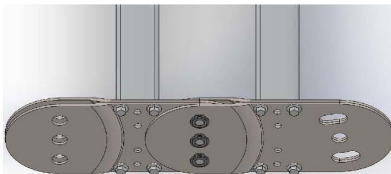
2.4. Montar dos partes mediante un nuevo eje y arandelas de retención
